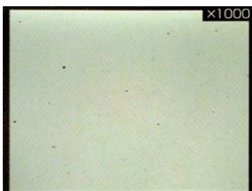
処理前 (ラップ面) Ra0.004 Rz0.026 (μm)
